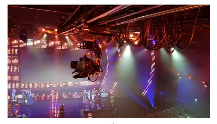
De railcam is een remote dolly die ondersteboven over een rail rijdt. Deze rail wordt bevestigd aan een standaard truss.
