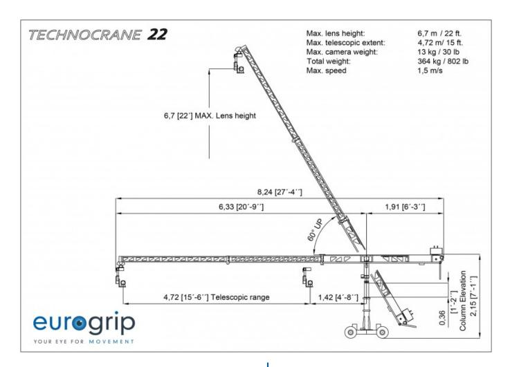
De Technocrane 22 TARGET is de eenmans- bedienings versie van de Technocrane 22. Niet enkel zwaaien en de telescopie, maar nu ook de head en camera bediening. En dit alles door 1 persoon.
